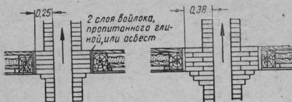
Рис. 103. Схема устройства горизонтальных разделок.
