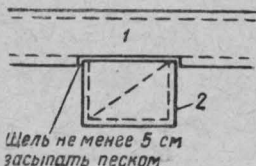
Рис. 114. Устройство фундамента печи рядом с фундаментом капитальной стены: 1 — фундамент капитальной стены; 2 — фундамент печи.
