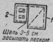
Рис. 113. Устройство фундамента печи рядом с фундаментом коренной трубы: 1 — фундамент печи; 2 — фундамент коренной трубы.
